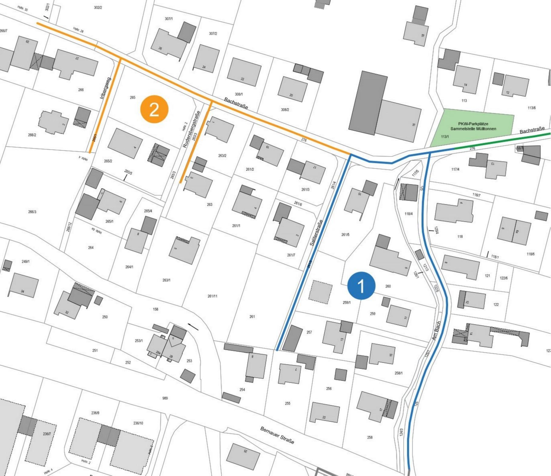
Mit den Arbeiten des **Bauabschnitt 1** wurde bereits begonnen. Nachdem die Fernwärmeleitungen in **Bauabschnitt 1** verlegt und vorgespannt sind, wird mit der Verfüllung des Rohrgrabens begonnen.
